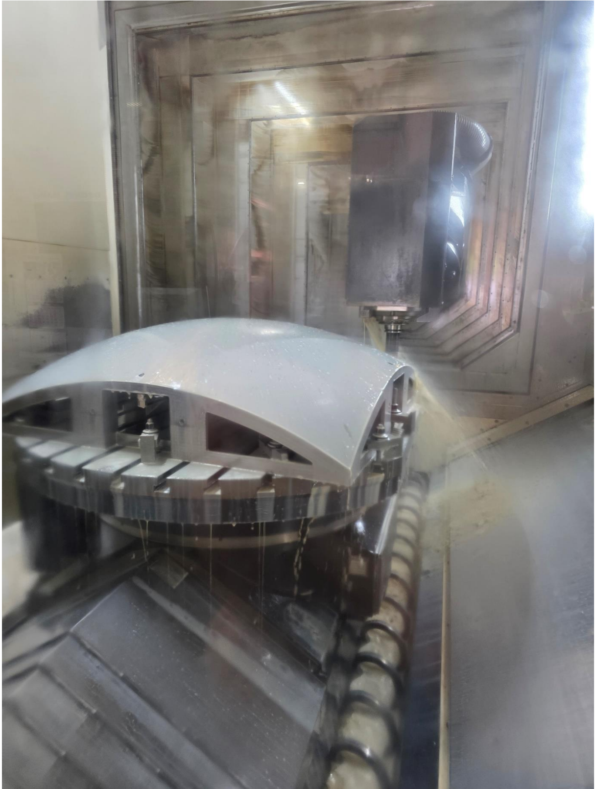
Abbildung 8 – Fertigungsschritt 8 (Fräsen Oberseite Tooling)
