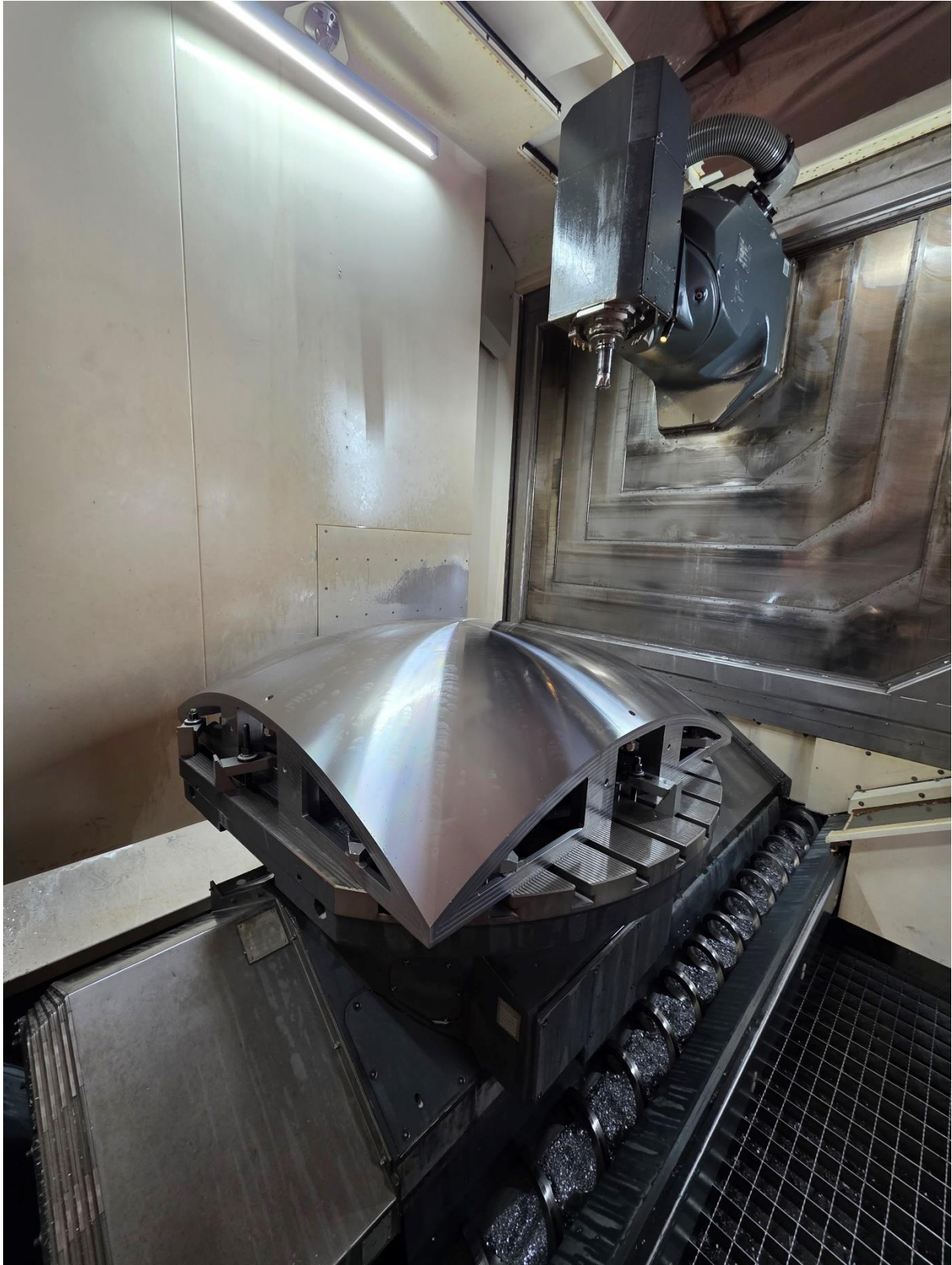
Abbildung 9 – Fertigungsschritt 9 (Schichten Oberseite Tooling)
