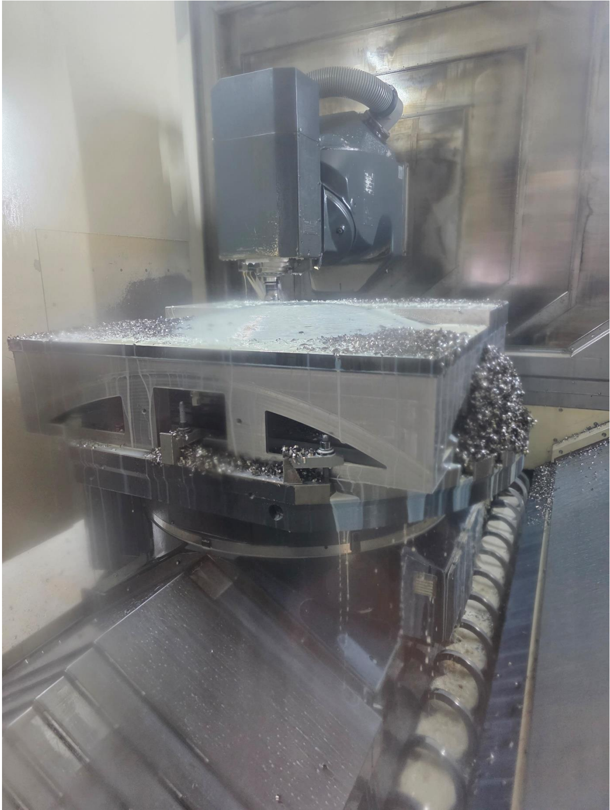
Abbildung 7 – Fertigungsschritt 7 (Umspannen und Fräsen Oberseite Tooling)
