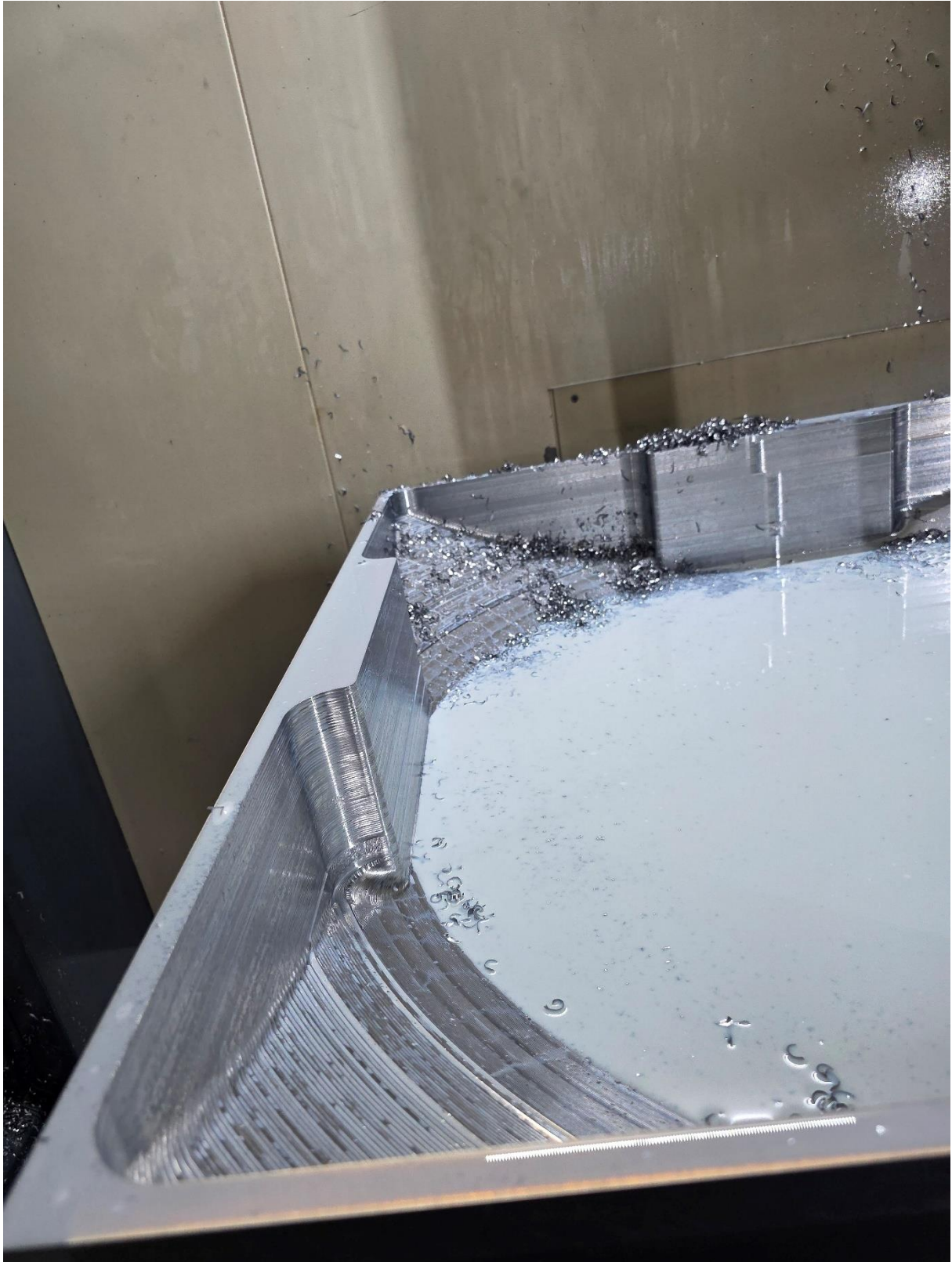
Abbildung 2 – Fertigungsschritt 2 (Erste Fräsungen)
