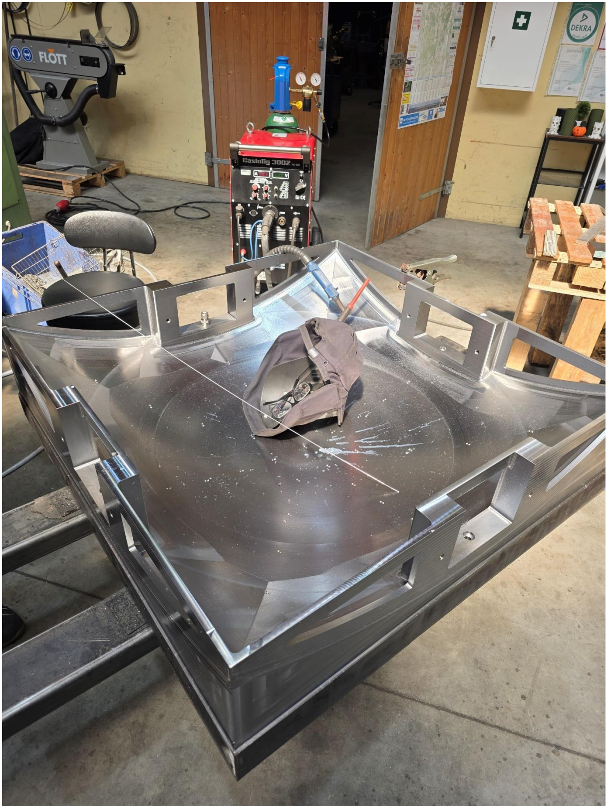
Abbildung 6 – Fertigungsschritt 6 (Einschweißen von Vakuumanschlüssen)
